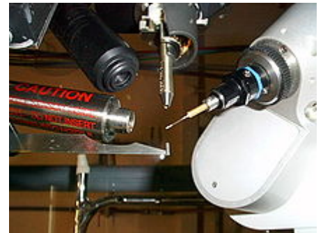
Diffractomètre pour rayons X à géométrie « kappa », muni d'un système cryogénique et d'un détecteur CCD.
