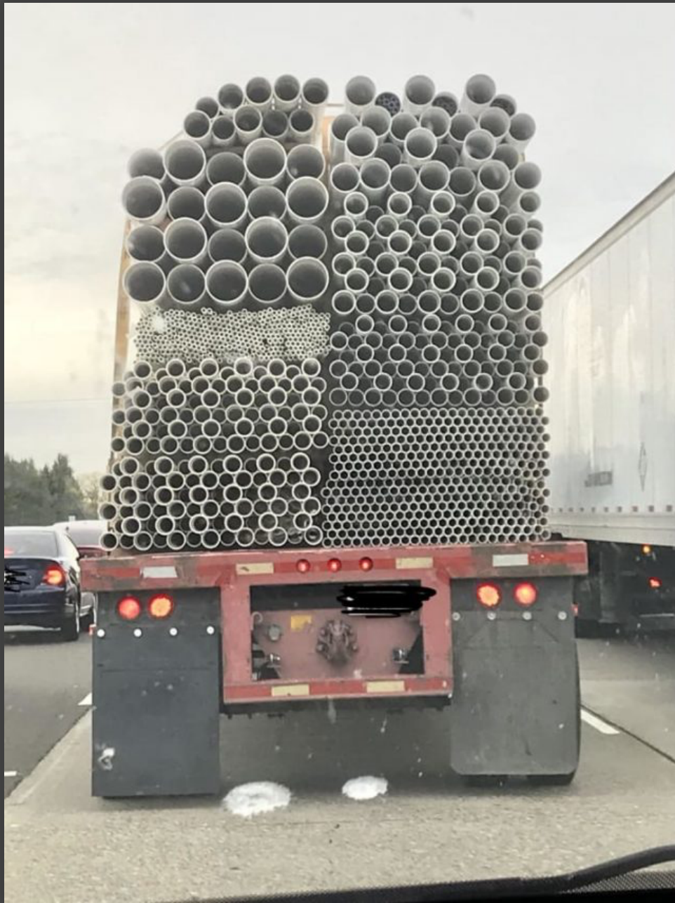
04 – Tuyaux de PVC rangés par diamètre sur la remorque d'un camion
